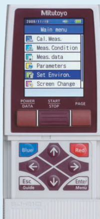
Защитная крышка клавиатуры открыта
