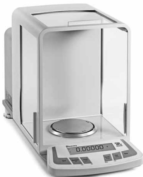
**Весы Discovery (DV)** – модель аналитических весов, пришедшая на смену проверенной временем и простой в обслуживании модели Analytical Plus (AP). Весы DV обладают самыми высокими метрологическими характеристиками и полным набором современных функций.
