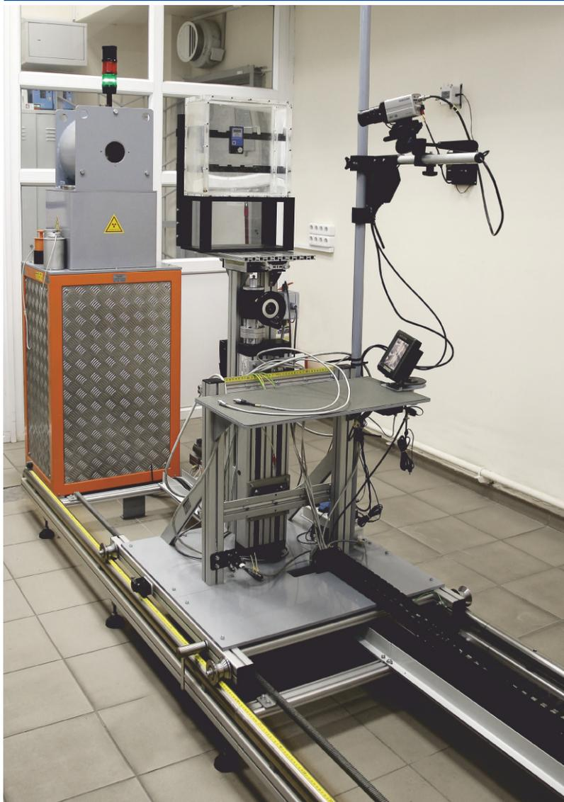
Эталонная дозиметрическая установка гамма-излучения предназначена для воспроизведения и передачи единиц кермы в воздухе, экспозиционной дозы, амбиентного, индивидуального эквивалентов дозы и их мощностей гамма-излучения рабочим эталонам и средствам измерений при поверке, калибровке и испытаниях.
