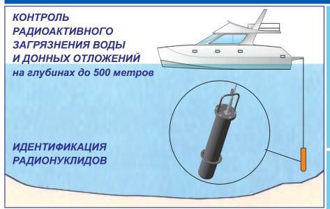
Погружные многофункциональные спектрометры предназначены для обеспечения радиационного мониторинга пресной и морской воды, а также донных отложений. Измерения проводятся на глубинах до 500 м без предварительного пробоотбора и пробоподготовки.
