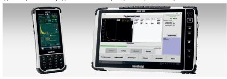
Использование алгоритмов обработки аппаратурных спектров, реализованных в прикладном программном обеспечении, позволяет получить данные о радиоизотопном составе и объемной активности по отдельным радионуклидам.
